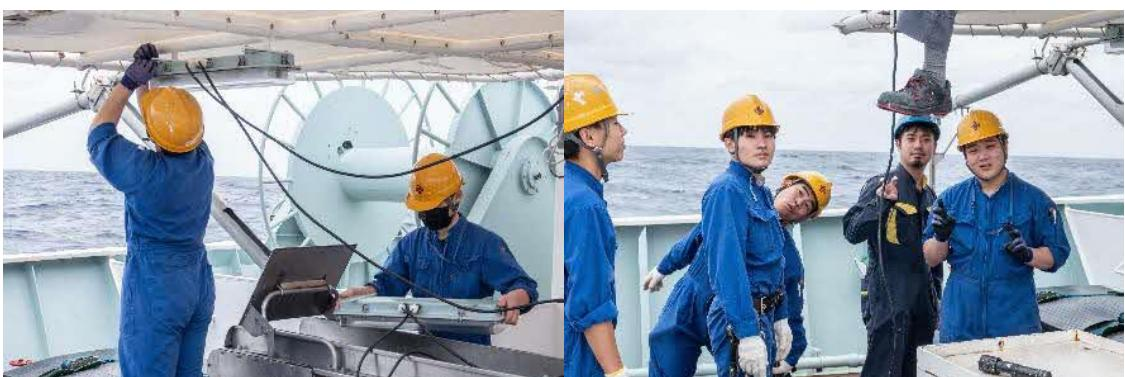
漁ろう機器の設置作業の様子です。写真は幹縄を回収するための機器と運搬用のベルトコンベアの様子です。実習生仲良く元気に作業しています。
