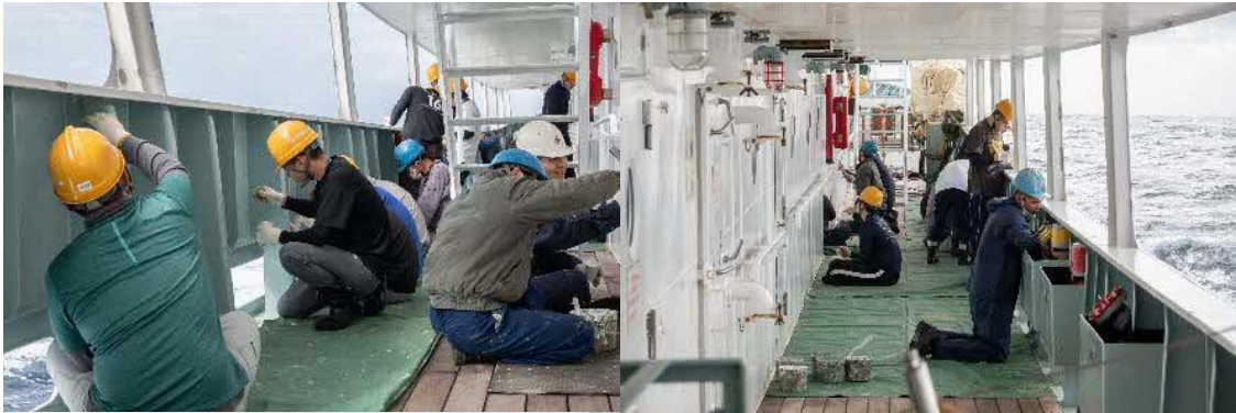
専攻科生は船体整備を行いました。 船体を長持ちさせるためには、こまめに錆 を落とし、塗装し直すことが大切です。 機関科の実習生は機器の手入れも行いま した。
